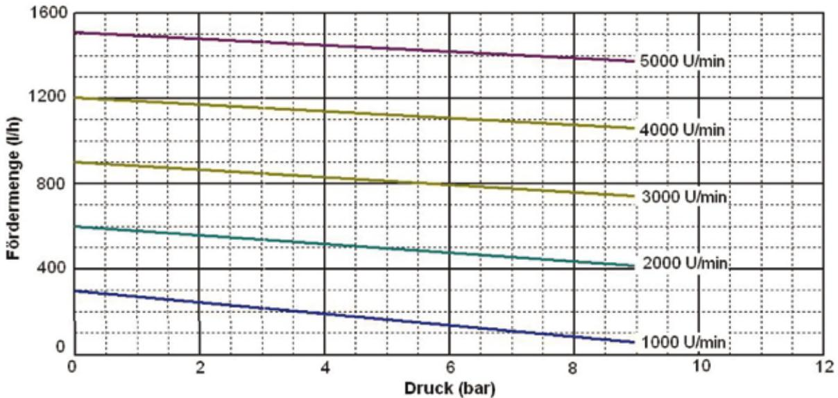
Die dargestellten Kennlinien gelten für: 1 bar Saugdruck; 20°C Medientemperatur; 1 cSt Medienviskosität
