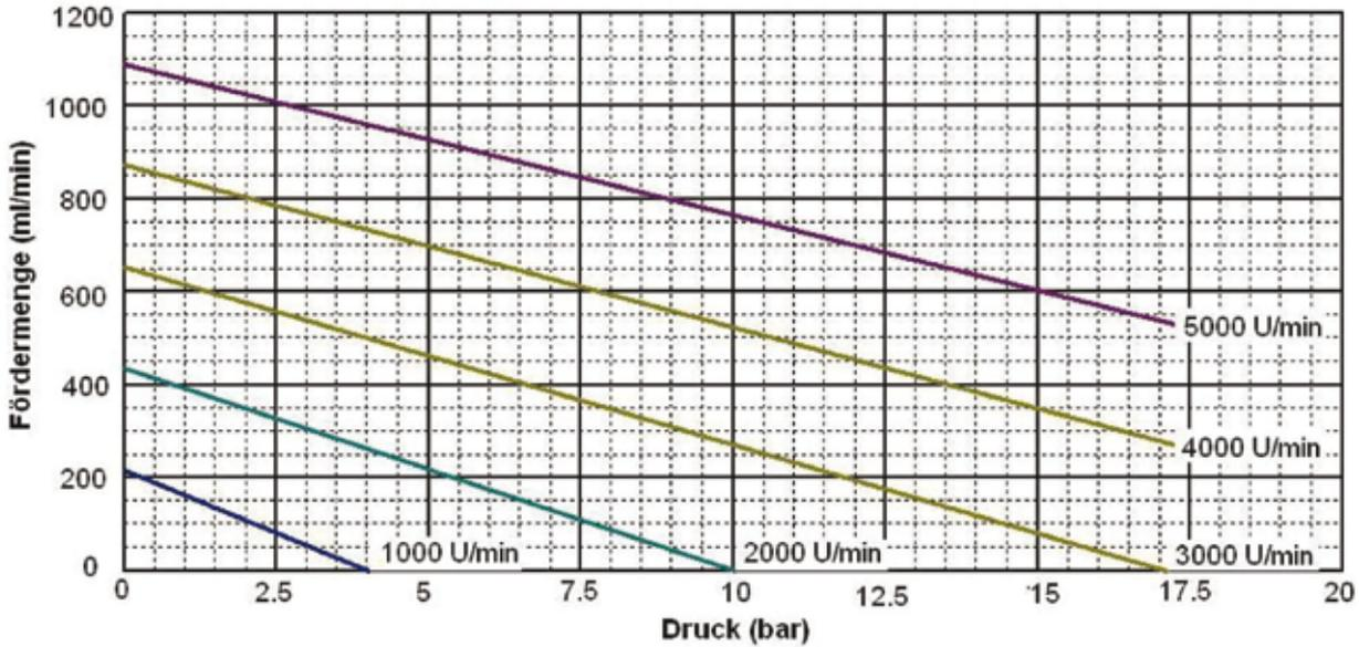
Die dargestellten Kennlinien gelten für: 1 bar Saugdruck; 20°C Medientemperatur; 1 cSt Medienviskosität; By-Pass Ventil komplett geschlossen
