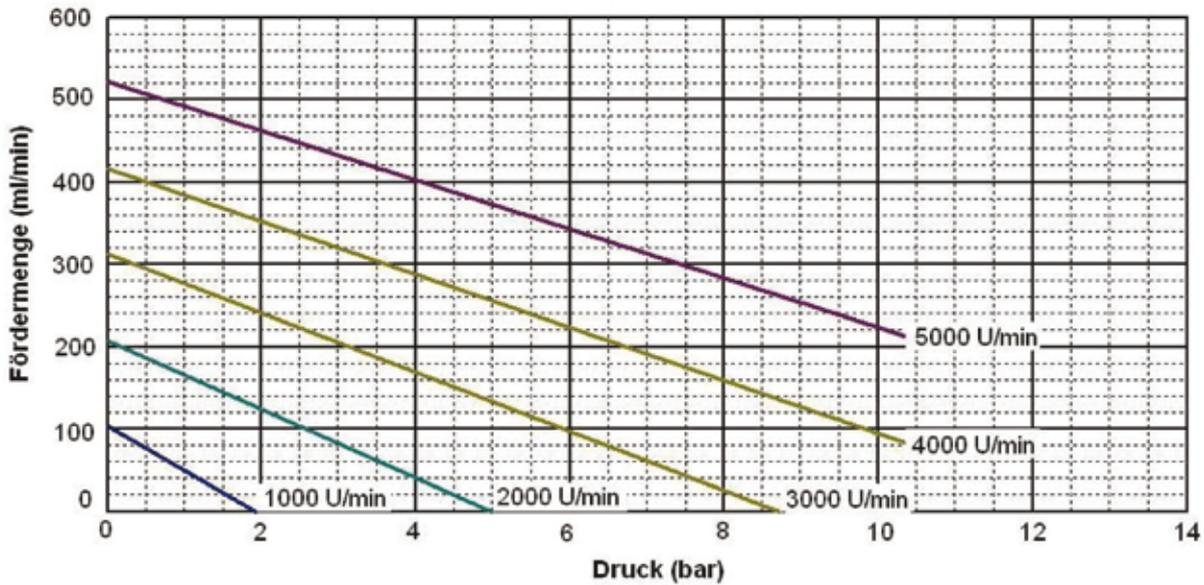
Die dargestellten Kennlinien gelten für: 1 bar Saugdruck; 20°C Medientemperatur; 1 cSt Medienviskosität; By-Pass Ventil komplett geschlossen
