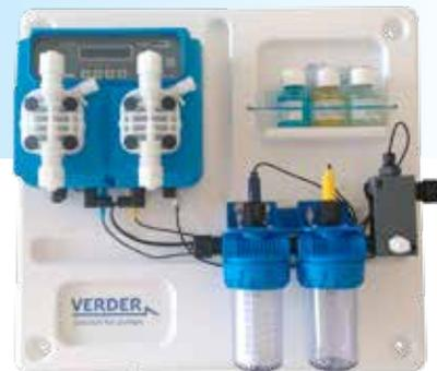
VE DUAL pH/Rx Paneele sind eine kompakte und effiziente Komplettlösung für die Überwachung und Regulierung des pH- und Redox-Wertes im Poolwasser. Die Paneele beinhalten einen Controller mit integrierten Pumpen, Sonden, Messzellenaufnehmer und weiteres Equipment.
