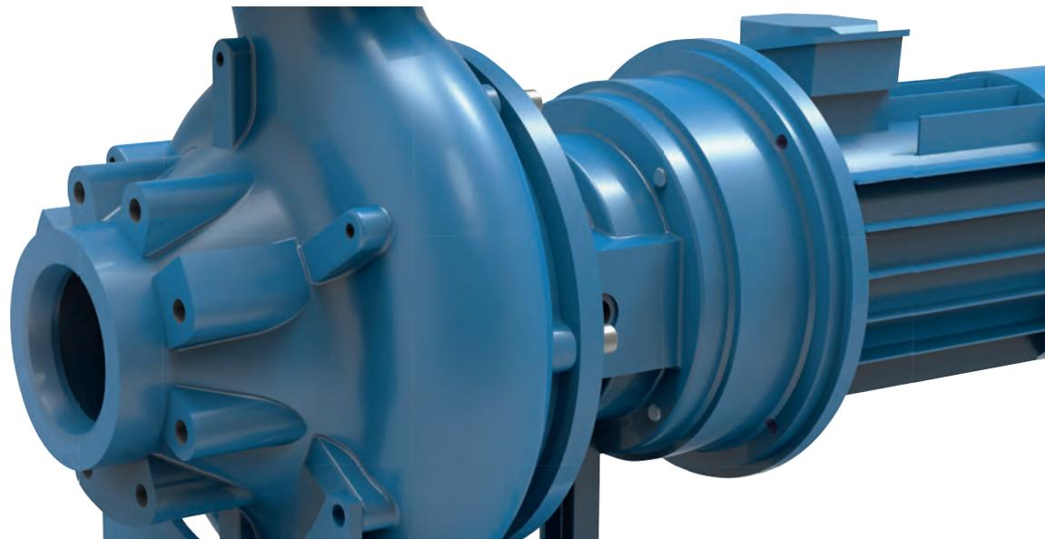
Um Kosteneinsparungen zu ermöglichen, hat Verderhus eine Schraubenkanalpumpe entwickelt, die speziell auf einen hohen Wirkungsgrad und niedrigere Betriebskosten ausgelegt ist. Das spezielle Laufrad und grosse Austrittsöffnungen sorgen für einen hohen Wirkungsgrad (auch beim Fördern von dicken Flüssigkeiten). Lange Fasern, die sich verzopfen und verspinnen können, sind dadurch kein Problem mehr. Aufgrund des gut durchdachten und soliden Pumpendesigns sind die Wartungskosten besonders niedrig.
