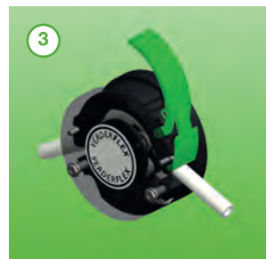
3 Skischuhschnalle öffnen und den Schnappverschluss über dem Sattel platzieren
