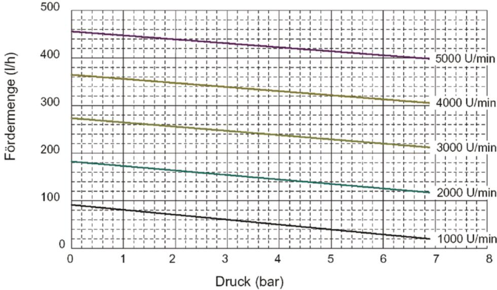
Die dargestellten Kennlinien gelten für: 1 bar Saugdruck; 20°C Medientemperatur; 1 cSt Medienviskosität; By-Pass Ventil komplett geschlossen
