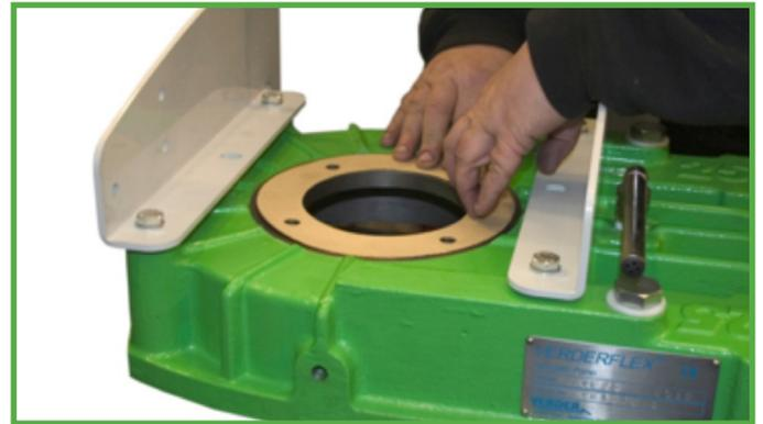
Figure 7 Installer le joint du système d'entraînement
