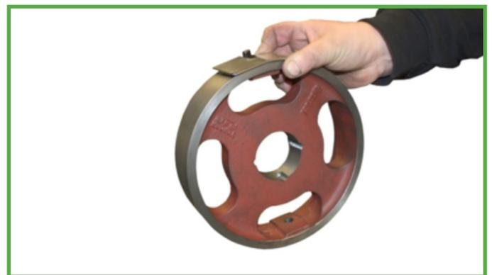
Figure 9 Montage des cales sur le rotor (étape 1)
