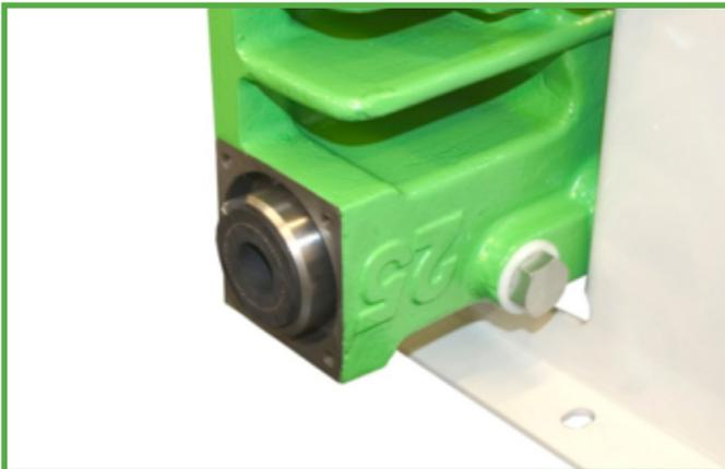
Figure 15 Installation de la bague d'étanchéité
