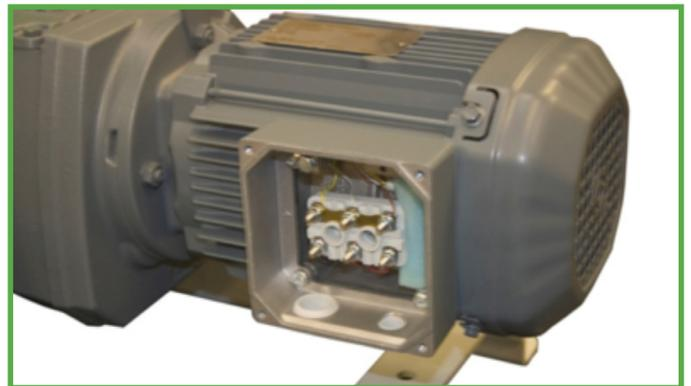
Figure 13 Raccordement du rotor
