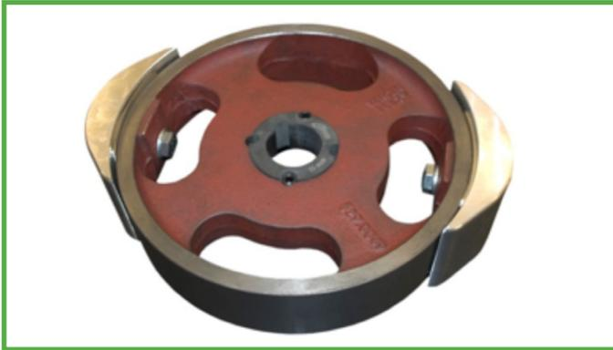
Figure 10 Montage des patins sur le rotor (étape 1)
