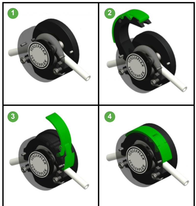
Figure 5 Installation du tube sur une pompe Rapide S
