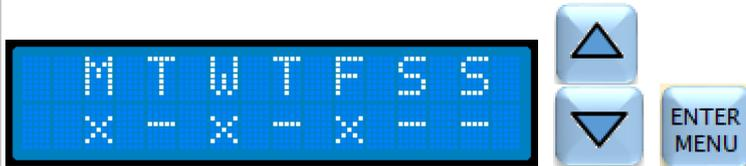
Wählen Sie anschließend die Startzeit der Dosierung, die zu dosierende Menge in ml unter **mL Dos** (Dosierung (ml)), die Durchflussrate der Dosierung unter **% Flowrate** (Durchflussrate %) und schließlich die Wochentage aus, an denen die Pumpe die Dosierung durchführen soll. Die Dosierung wird mit „x“ aktiviert.
