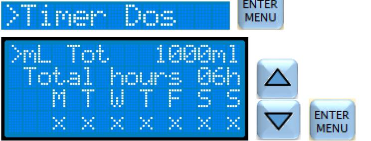
Wählen Sie im Menü **Dosing** (Dosierung) mit dem Cursor die Option **Timer Dos** (Timer-Dosierung) aus, und drücken Sie die **ENTER**-Taste.
