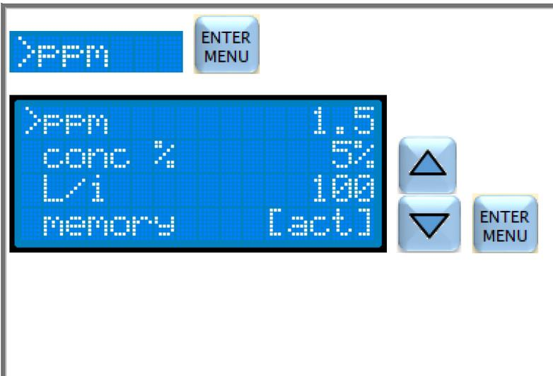
Wählen Sie im Menü **Dosing** (Dosierung) mit dem Cursor die Option **ppm** aus, und drücken Sie die **ENTER**-Taste.
