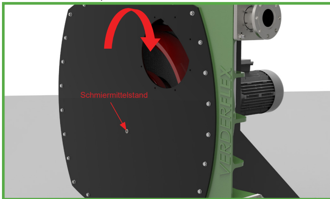
Abbildung 27 Befüllen der Pumpe mit Schmiermittel
