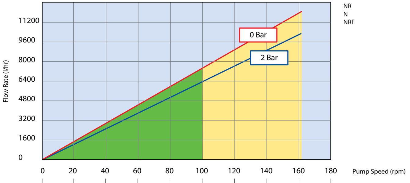
kontinuierlicher Betrieb (SP) Standard Rotor
