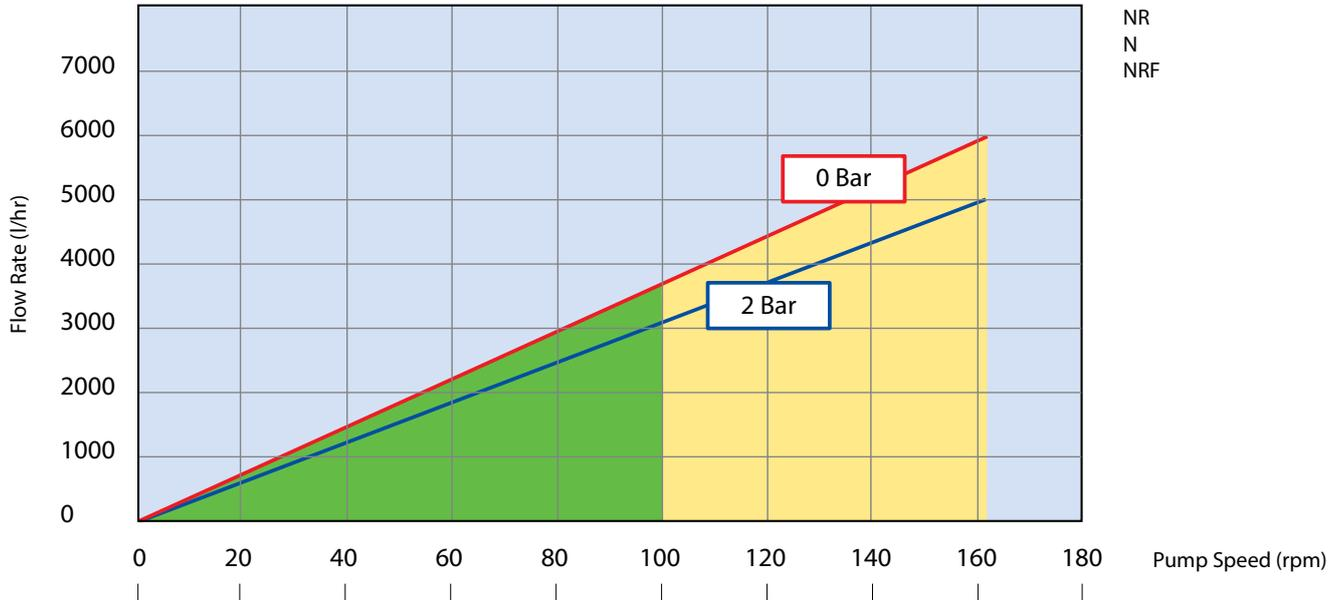
kontinuierlicher Betrieb (SP) Standard Rotor
