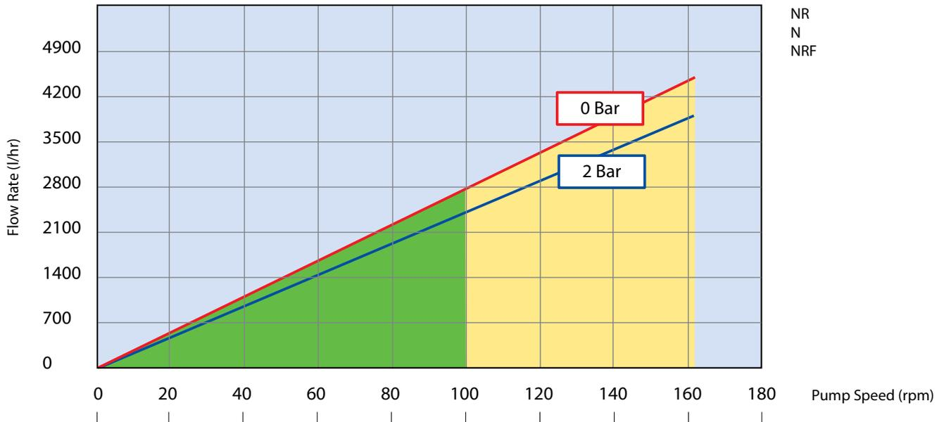
kontinuierlicher Betrieb (SP) Standard Rotor
