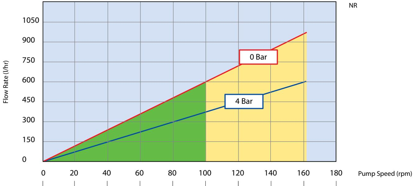
kontinuierlicher Betrieb (SP) Standard Rotor ■ SP Intervallbetrieb max. 1 Std. Laufzeit min. 1 Std. Pause ■
