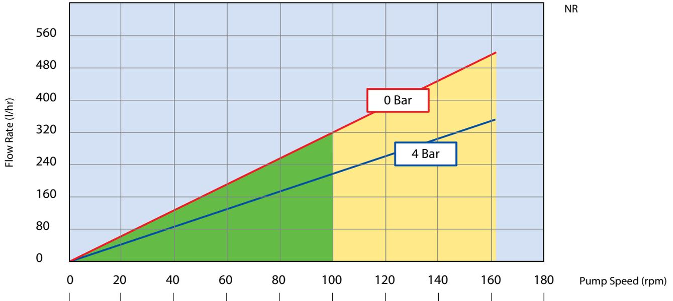
kontinuierlicher Betrieb (SP) Standard Rotor
