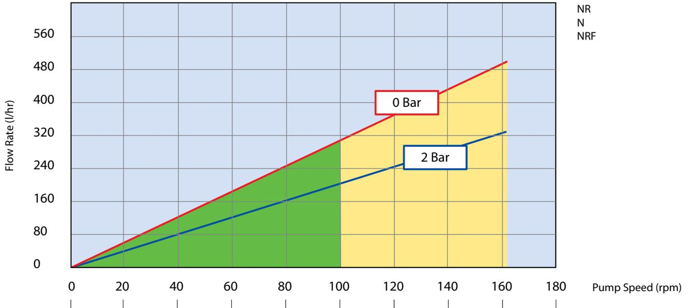
kontinuierlicher Betrieb (SP) Standard Rotor
