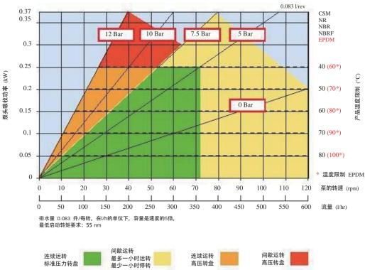
上图所示的流量是使用没有吸水高度或排放压力的20°C水测定的。
