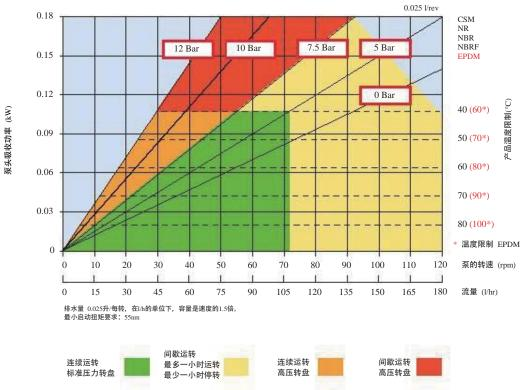
上图所示的流量是使用没有吸水高度或排放压力的20℃水测定的。
