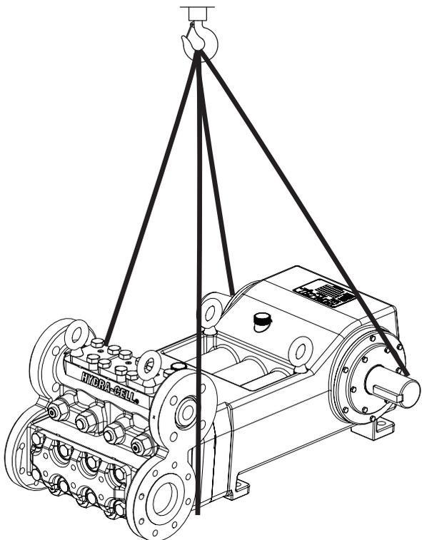
Abb. 3 Hebezeug befestigen an Pumpe
