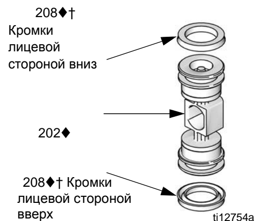
Рис. 2. Установка u-образных уплотнений пневмоклапана
