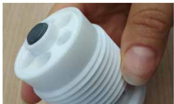
Prüfen Sie durch Berührung, ob der Sensor richtig auf den Kontakt reagiert. Bei Berührung sollte die LED aufleuchten. Der LS-Dämpfer kann jetzt in das Pumpengehäuse (15 oder 25) eingeschraubt werden (Abbildung 16).
