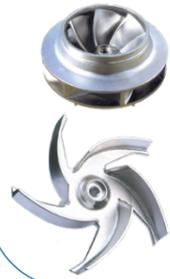
Schwere Kreiselpumpen aus Edelstahl mit Laufrädern aus Feinguss. Diese sind stabiler und unempfindlicher gegen Spaltkorrosion und Verstopfung als typische Wasserpumpen mit punktgeschweißten Laufrädern.
