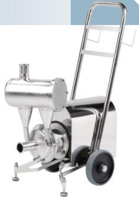
CRP系列泵产品是欧洲卫生设备设计组织（EHEDG）认证的完全可清洁的空气处理泵，主要用于抽送液体与空气的混合物。可用在乳品厂、啤酒厂、饮料业和酿酒厂等几乎所有的拥有最严苛卫生应用程序要求的行业中。这些完全可清洁的泵产品拥有316L不锈钢泵体安装在厚冷轧钢板中，100%无缝隙，非常光滑。具有开式或闭式熔模铸造叶轮，安装在316L的泵体或复合材料中。由于其无缝隙设计和电抛光工艺作为最后的表面处理，CRP系列泵产品是完全可清洁的，成为您生产过程中可靠的组成部分。
