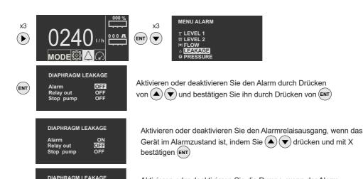
Aktivieren oder deaktivieren Sie die Pumpe, wenn der Alarm ausgelöst wird, indem Sie vollen drücken und durch Drücken von ENT bestätigen.
