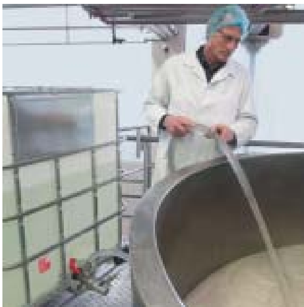
Přečerpávání média přes výpust IBC nahoru do míchací nádoby.
