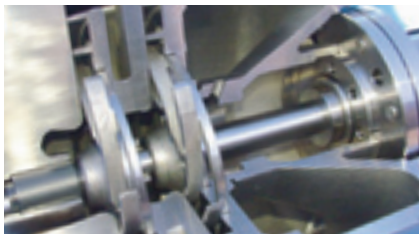
Doorsnede van een pomp uit de LBM-serie.
