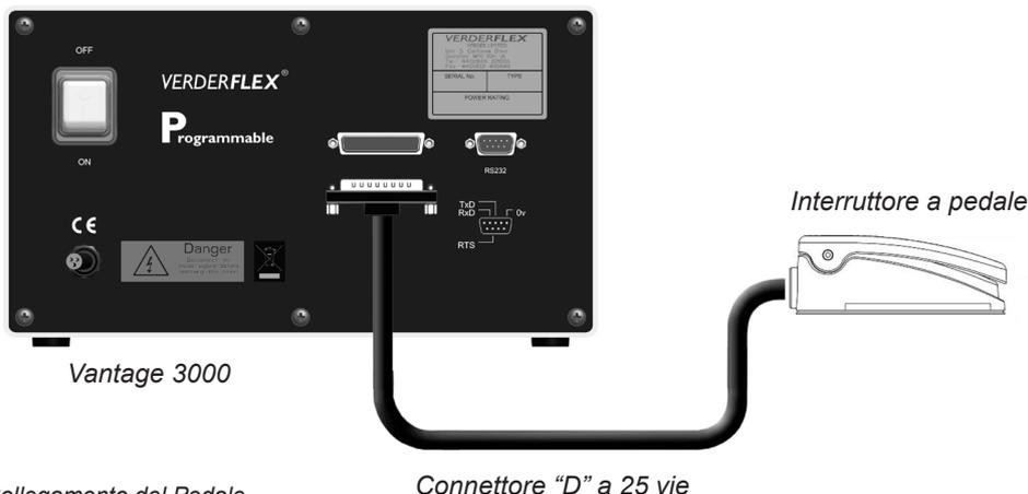
Figure 6 Collegamento del Pedale
