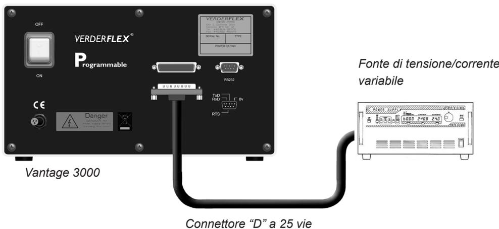
Figura 7 Collegamento di una Fonte Variabile di Tensione/Corrente
