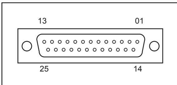
Figura 2 Connettore tipo 'D' a 25 vie
