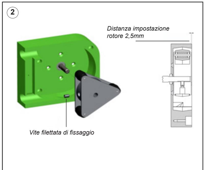
Tabella 9 Sostituzione del Rotore – Testa R3i
