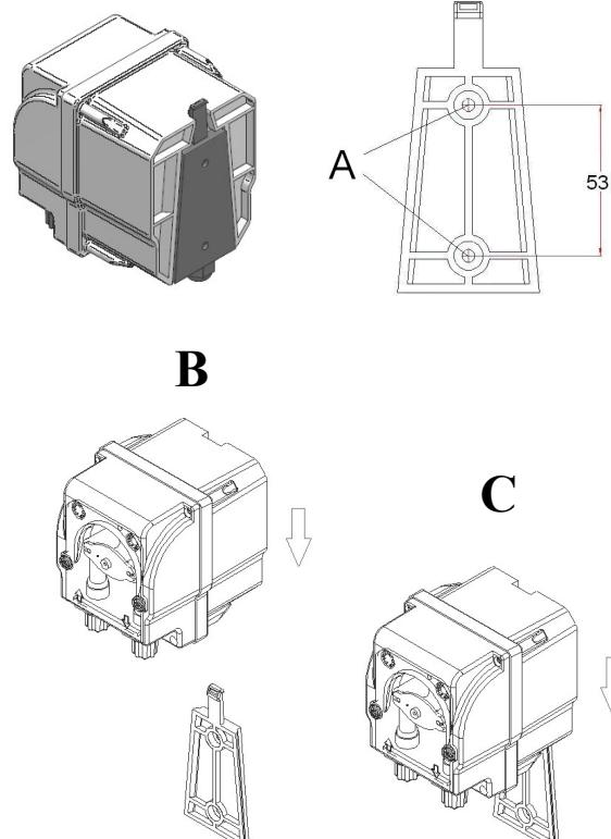
**I** Per fissare a muro la pompa praticare 2 fori (A) allineati verticalmente a distanza di 53 mm sul supporto verticale a cui si vuole appendere la pompa. Fissare la staffa al supporto con il corredo dei tasselli in dotazione. A questo punto bloccare la pompa alla staffa come mostrato nelle figure B e C. Completata l'operazione accertarsi della stabilità del fissaggio.
