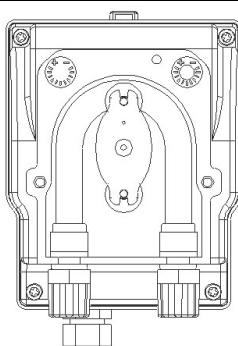
**I** Inserire il raccordo di destra nella propria sede e rimontare il coperchio avvitando le due viti del frontale
