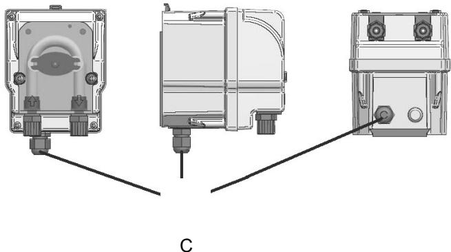
**I** Il cavo elettrico di alimentazione della pompa è quello che esce dal pressacavo C in figura .
