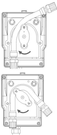
**I** Inserire il raccordo di sinistra del nuovo tubo, nella propria sede, facendo attenzione che la parte arrotondata si posizioni verso l'interno. Girare il portarullini in senso orario in modo che il tubo occupi la propria sede naturale
