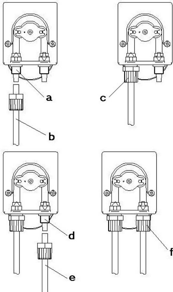
I **Aspirazione:** Collegare il tubo di aspirazione (b) al raccordo di aspirazione (a). Serrare la ghiera (c).
