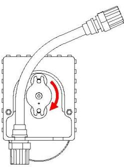
**I** Inserire il raccordo di sinistra del nuovo tubo, nella propria sede, facendo attenzione che la parte arrotondata si posiziona verso l'interno. Girare il portarullini in senso orario in modo che il tubo occupi la propria sede naturale
