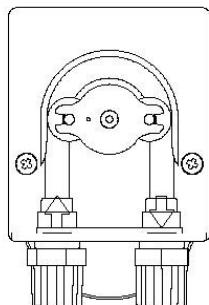
**I** Inserire il raccordo di destra nella propria sede e rimontare il coperchio avvitando le due viti del frontale
