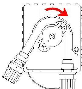
**I** Rimuovere il coperchio trasparente svitando le due viti sul frontale. Togliere il vecchio tubo sbloccando prima il raccordo di sinistra, girando nel senso della freccia il portarullino in modo da liberare il tubo fino al raccordo di destra.
