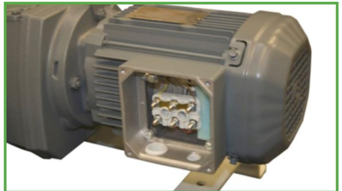
Figura 13 Collegamento del motore
