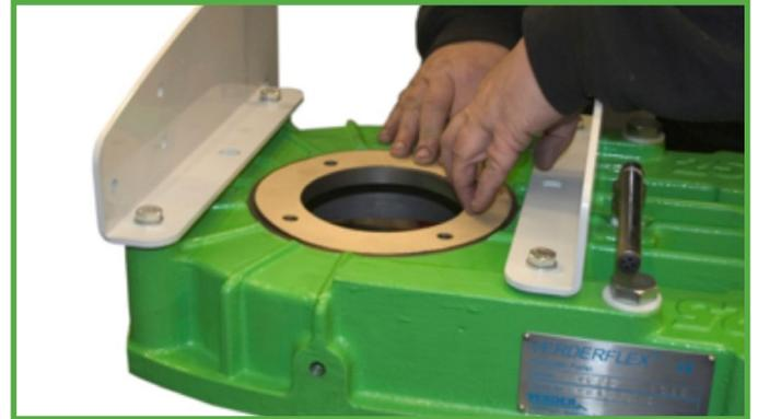
Figura 7 Montaggio della guarnizione della trasmissione
