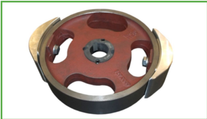
Abbildung 10 Anbringung der Rotorscheuhe am Rotor (Schritt 2)
