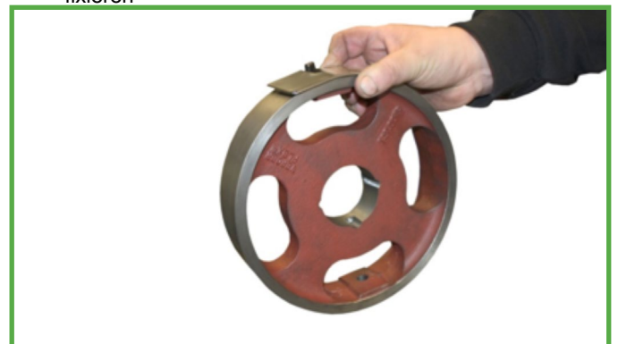
Abbildung 9 Anbringung der Rotorscheiben am Rotor (Schritt 1)
