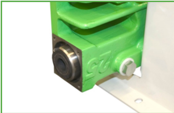
Figure 15 Installation de la bague d'étanchéité
