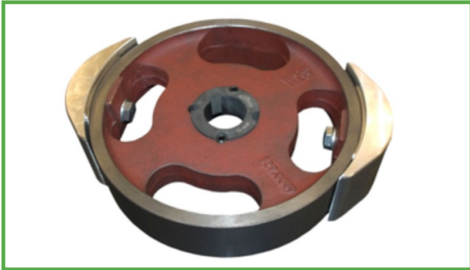
Figuur 10 Monteren van rotorschoeven op de rotor (Stap 2)
