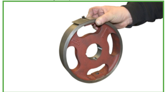
Figuur 9 Monteren van rotorvulplaatjes op de rotor (Stap 1)
