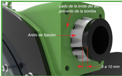
Figura 9 Anillo de fijación insertado
