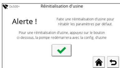
Figure 37. - Restauration des paramètres d'usine
