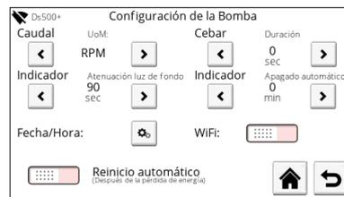
Figura 26. - Ajustes de la bomba
