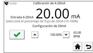
Figura 19. - Calibración(3) de 4-20 mA
