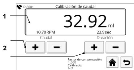
Figura 22. - Calibración de caudal
