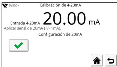
Figura 18. - Calibración(2) de 4-20 mA
