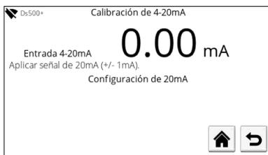
Figura 17. - Calibración(1) de 4-20 mA
