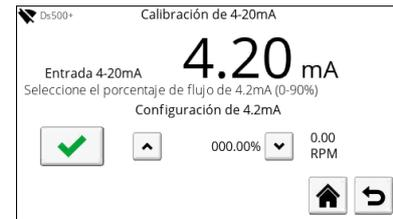
Figura 20. - Calibración(4) de 4-20 mA
