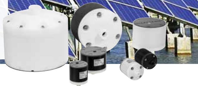
En raison du principe de fonctionnement, les pompes à double membrane génèrent un débit pulsatoire. En utilisant un amortisseur de pulsations Verderair en combinaison avec la pompe, les pulsations seront réduites au minimum.
