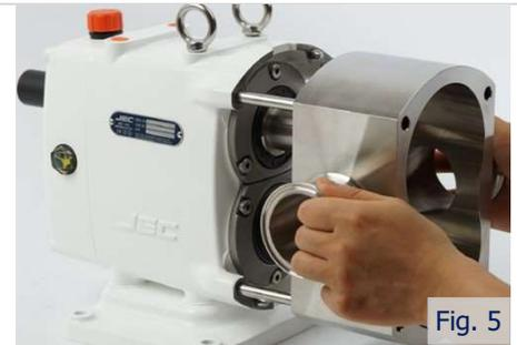
Au cours de cette étape, veillez à garder les cales en haut et en bas ensemble et en place pour éviter les pertes, les dommages et les désalignements. Ils sont sélectionnés et assemblés en usine comme des pièces spécifiques.
