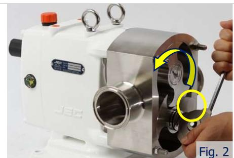
Les rotors peuvent être retirés du corps de pompe en tirant vers l'avant.
