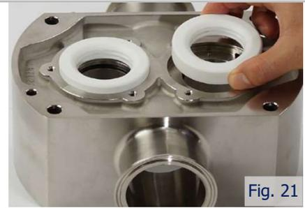
Lors de l'installation du corps de pompe sur la boîte d'engrenages, les joints à lèvres peuvent être très étroits pour le montage sur les arbres. Dans ce cas, tapoter le corps de pompe uniformément vers l'arrière sur la boîte à engrenages avec un marteau doux ou vissez en étoile les écrous sur les tiges filetées et tirez le corps vers la boîte à engrenages délicatement.
