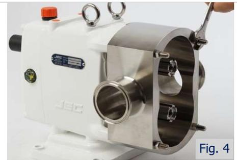
Une fois les rotors retirés des arbres, le carter de rotor peut être retiré de la boîte d'engrenages en le faisant glisser sur les goujons. Inspectez le corps de pompe pour l'usure et les dommages, nettoyez et continuez l'entretien de la garniture mécanique le cas échéant.
