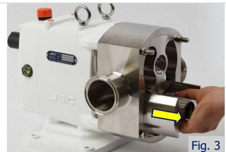
Retirez les écrous hexagonaux des quatre goujons fixant le boîtier du rotor à la boîte d'engrenages.
