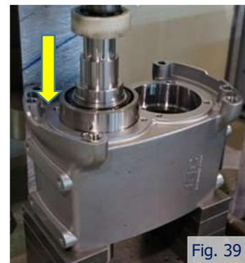
2. Lubrifiez les joints d'huile de roulement avant avec de l'huile et installez-les dans les couvercles de roulement. Placez les couvercles de roulement avant sur les deux arbres et assurez-vous que les lèvres des joints d'huile ne se replient pas. Placez les rondelles et les boulons et serrez-les.
