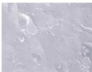
Surface polie mécaniquement / projection de billes
