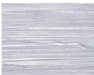
Les surfaces électropolies ont une résistance à la corrosion extrêmement élevée et une qualité de surface optimale, permettant d'obtenir des conditions hygiéniques idéales pour éviter le dépôt de bactéries et prévenir la formation de germes.
