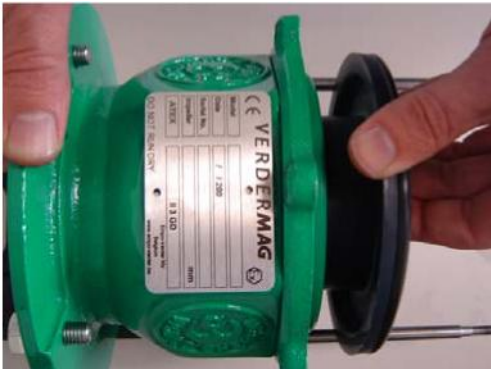
Abbildung 14: Zusammenbau von Spalttopf und Adapterglocke
