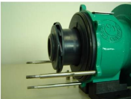
Abbildung 15: Zusammenbau von Laufrad und Spalttopf
