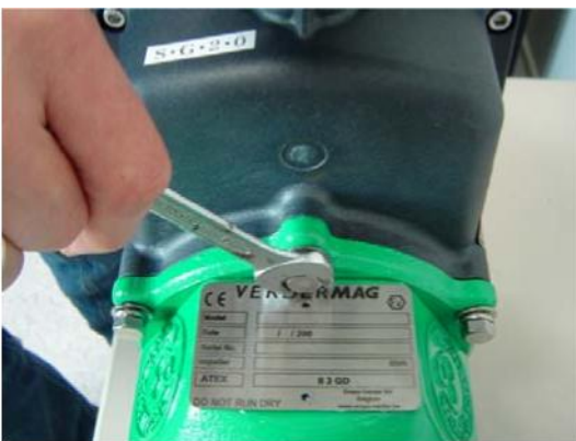
Abbildung 18: Zusammenbau der Pumpe
