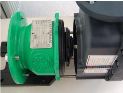
Abbildung 17: Zusammenbau der Pumpe
