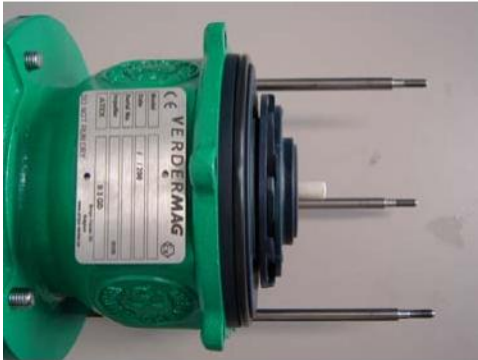
Abbildung 16: Adapterglocke und Laufrad fertig montiert.
