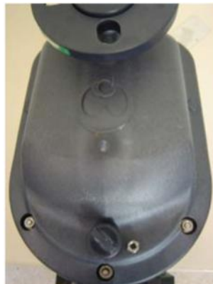
Abbildung 1: Beginn der Demontage von Nassteil / Antriebsteil
