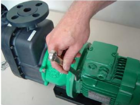
Abbildung 23: Abschluss der Pumpenmontage
